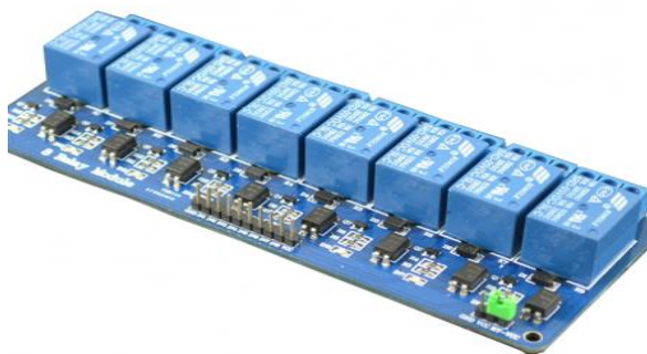
Hình 2.3. Module relay 8 kênh
