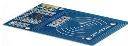
Hình 1. Thiết bị đọc MFRC522
